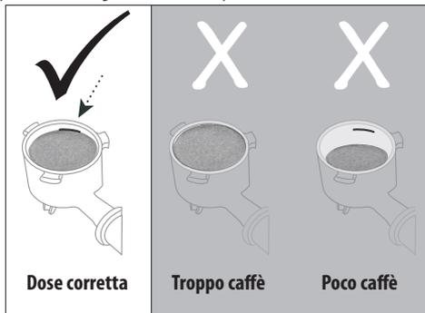
Dopo la prima macinatura, ruotare gradualmente la manopola (B2) partendo dalla posizione ☒ "min" (vedi figura seguente), fino al raggiungimento della dose corretta, in funzione del tipo di caffè: la posizione ideale sarà identificata all'interno del settore evidenziato in grigio nella figura seguente.
