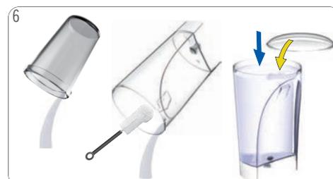
6 Contenitore vuoto e pulito. Risciacquare e pulire il serbatoio dell'acqua. Utilizzare uno spazzolino pulito adatto ad uso alimentare e un detersivo liquido se necessario. Riempirlo in seguito con acqua potabile fresca e inserirlo nella macchina.
