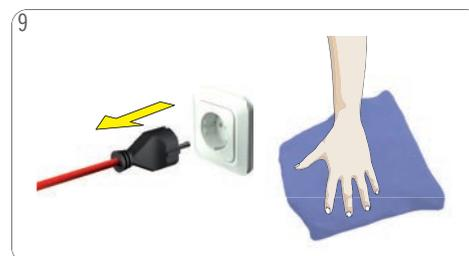
Scollegare la spina di alimentazione! Pulire la macchina con uno straccetto umido. Asciugarla in seguito con uno straccetto asciutto.
