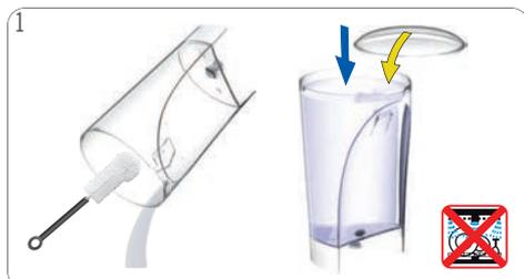
Risciacquare e pulire il serbatoio dell'acqua. Utilizzare uno spazzolino pulito adatto ad uso alimentare e un detersivo liquido se necessario. Riempirlo in seguito con acqua potabile fresca e inserirlo nella macchina. Il serbatoio dell'acqua non può essere lavato nella lavastoviglie!
