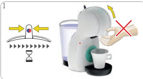
1 Spostare la leva di selezione in posizione "STOP". Aprire la leva di blocco. Se la leva di blocco non può essere aperta, attendere per 20 minuti, riprovare.
