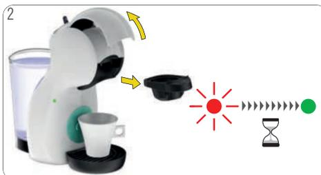
2 Aprire la leva di blocco. Estrarre il supporto per capsule. La macchina si accende automaticamente. L'indicatore LED inizia a lampeggiare in rosso mentre la macchina è in fase di riscaldamento per circa 40 secondi. In seguito l'indicatore rimane fisso sul verde. La macchina è pronta all'uso.
