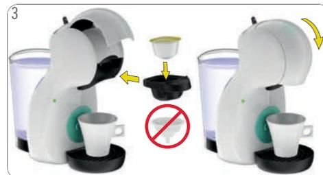
3 Assicurarsi che l'utensile per il risciacquo non sia all'interno. Inserire la prima capsula nell'apposito supporto. Reinsierlo nella macchina. Chiudere la leva di blocco.
