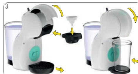
3 Aprire la leva di blocco. Collocare l'utensile per il risciacquo nel supporto per capsule. Inserire il supporto per capsule nella macchina. Chiudere la leva di blocco. Rimuovere la vaschetta. Posizionare un contenitore grande vuoto sotto l'uscita del caffè.
