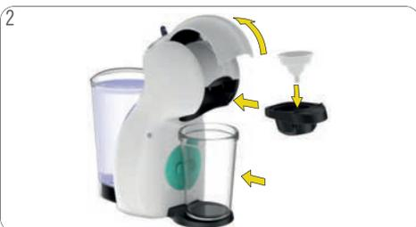
2 Aprire la leva di blocco. Collocare l'utensile per il risciacquo nel supporto per capsule. Inserire il supporto per capsule nella macchina. Posizionare un contenitore grande vuoto sotto l'uscita del caffè.
