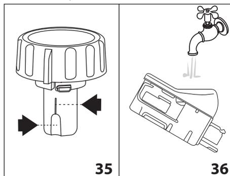
5. Sciacquare l'interno della sede della manopola regolazione schiuma con acqua corrente (fig. 36);
