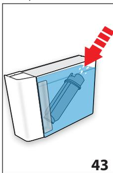
8. "IMMERGERE FILTRO LASCIANDO USCIRE L'ARIA" (fig. 43): Inserire il filtro nel serbatoio acqua e immergerlo completamente per una decina di secondi, inclinandolo e premendolo leggermente per permettere alle bolle d'aria di uscire. Premere il selettore in corrispondenza di "NEXT>";
