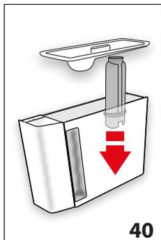
12. (Se il filtro era installato) "INSERIRE IL FILTRO NELLA SUA SEDE" (fig. 40). Premere il selettore corrispondente a "NEXT>" ed estrarre il serbatoio acqua, reinserire, se tolto precedentemente, il filtro addolcitore;
