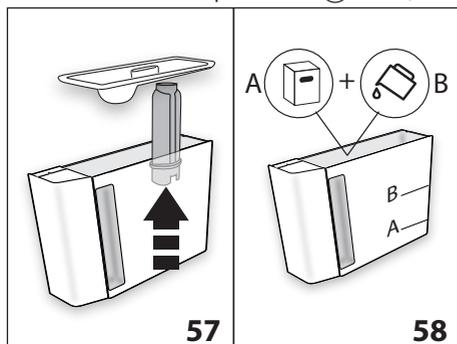
5. "VERSARE DECALCIFICANTE (LIVELLO A) E ACQUA (FINO A LIVELLO B)" (fig. 58); Versare nel serbatoio acqua il decalcificante fino al livello A (corrispondente a una confezione da 100ml) impresso sul lato interno del serbatoio; quindi aggiungere acqua (un litro) fino a raggiungere il livello B; reinserire il serbatoio acqua. Premere NEXT";
