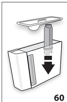
14. "SCIACQUARE E RIEMPIRE CON ACQUA FINO AL LIVELLO MAX" (fig. 5): Riempire il serbatoio fino al livello MAX con acqua fresca;
