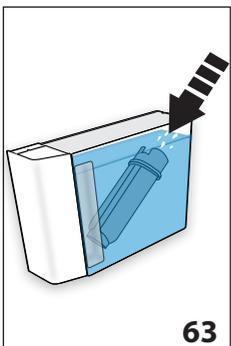
8. "IMMERGERE FILTRO NEL SERBATOIO LASCIANDO USCIRE LE BOLLE D'ARIA" (fig. 63): Inserire il filtro nel serbatoio acqua e immergerlo completamente per una decina di secondi, inclinandolo e premendolo leggermente per permettere alle bolle d'aria di uscire. Premere "➤ NEXT";
