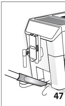
1. Controllare periodicamente (circa una volta al mese) che l'interno della macchina (accessibile una volta estratta la vaschetta raccogli-gocce - A14) non sia sporco.
