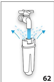
6. "FAR SCORRERE ACQUA NEI FORI FINCHÉ FUORISCE DALLE APERTURE" (fig. 62): Per attivare il filtro, far scorrere dell'acqua di rubinetto nel foro del filtro come indicato in figura fintantoché l'acqua fuoriesce dalle aperture laterali per oltre un minuto. Premere "➤ NEXT";
