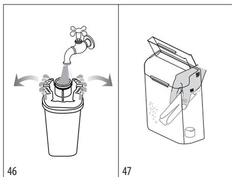
5. Inserire il filtro nel serbatoio acqua e immergerlo completamente per una decina di secondi, inclinandolo e premendolo leggermente per permettere alle bolle d'aria di uscire (fig. 47).
