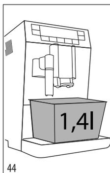
7. Versare nel serbatoio acqua il decalcificante fino al livello A (corrispondente a una confezione da 100ml) impresso sul retro del serbatoio (fig. 43); quindi aggiungere acqua (un litro) fino a raggiungere il livello B (fig. 43); reinserire il serbatoio acqua.
