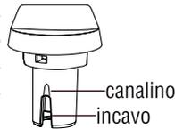
Prestare particolare attenzione che sull'incavo e sul canalino situato sotto la manopola (vedi figura accanto) non rimangano residui di latte: eventualmente raschiare il canalino con uno stuzzicadenti.
