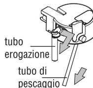
5. Verificare anche che il tubo pescaggio e il tubo erogazione non siano otturati da residui di latte.
