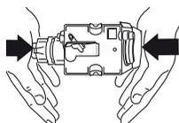
Se l'infusore è difficile da inserire, è necessario (prima dell'inserimento) portarlo alla giusta dimensione premendolo con forza
