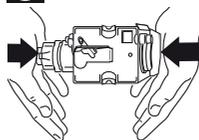
Se l'infusore è difficile da inserire, è necessario (prima dell'inserimento) portarlo alla giusta dimensione premendo le due leve come indicato in figura.
