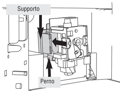
**i Nota Bene!** Se l'infusore è difficile da inserire, è necessario (prima dell'inserimento) portarlo alla giusta dimensione premendolo con forza contemporaneamente dalla parte inferiore e superiore come indicato in figura.
