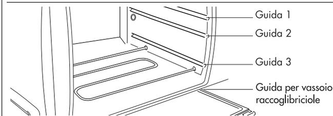
Il forno dispone di 3 guide per il posizionamento di teglie e griglie a diverse altezze
