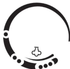
**Ricordatevi che la funzione vapore può essere impiegata solo con termostato (G) posizionato sul settore**
