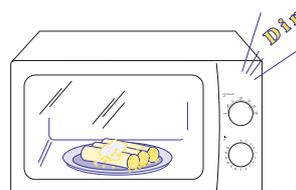
In qualsiasi momento è possibile interrompere il funzionamento riportando la manopola timer in posizione "0" ed è possibile variare la durata della cottura (durante lo svolgimento della stessa) girando tale manopola avanti o indietro.
