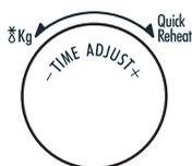
**1** Ruotare la manopola **TIME ADJUST** (8) verso sinistra: il display visualizzerà una serie di pesi (da 0,1 kg a 2 kg).
