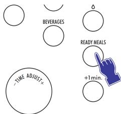
1. Premere il tasto **“funzioni automatiche”** desiderato. (Il display lampeggia sul tempo preimpostato mentre si accendono il secondo indicatore in alto a sinistra relativo al funzionamento a microonde e quello in basso relativo alla potenza delle microonde preimpostata).
