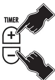
2 Impostare il tempo (max 99 minuti) premendo i tasti TIMER +/- (3) o (4). Tenere premuto il tasto per più di 2 secondi per far scorrere il tempo velocemente in su o in giù. Ad ogni pressione del tasto il tempo aumenta o diminuisce di 1 minuto.
