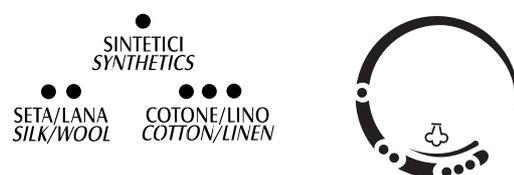
**Ricordatevi che la funzione vapore può essere impiegata solo con termostato (G) posizionato sul settore**
