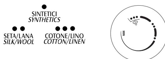
**Ricordatevi che la funzione vapore può essere impiegata solo con termostato posizionato sul settore**
