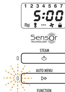
Al termine del pre-riscaldamento, è possibile inserire il dolce all'interno del forno. Premendo il tasto **START** (8) (oppure automaticamente dopo 1 minuto), il forno si avvierà nella funzione desiderata e il display mostrerà il conteggio del tempo mancante alla fine della cottura.
