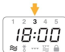
selezionare il livello di potenza delle microonde premendo ripetutamente il tasto **POWER LEVEL** (3) fino a far lampeggiare la potenza desiderata espressa in numeri posta nella parte superiore del display. Per la scelta della potenza, consultare sempre le tabelle riportate al Capitolo 3.
