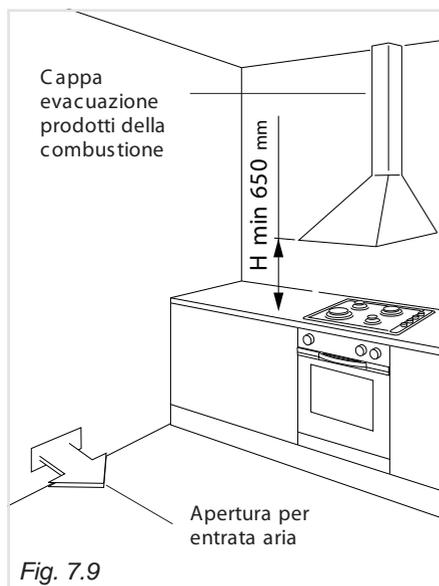
**Questo apparecchio non è raccordato ad un dispositivo di evacuazione dei prodotti della combustione. Esso deve essere installato e raccordato conformemente alle regole di installazione in vigore. Una particolare attenzione deve essere posta anche alla ventilazione del locale.**
