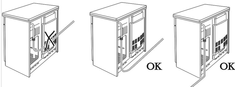
Il tubo non deve attraversare la lamiera posteriore della cucina. Eventualmente, se fosse necessario, far passare il tubo in vicinanza della parte inferiore dell'apparecchio.
