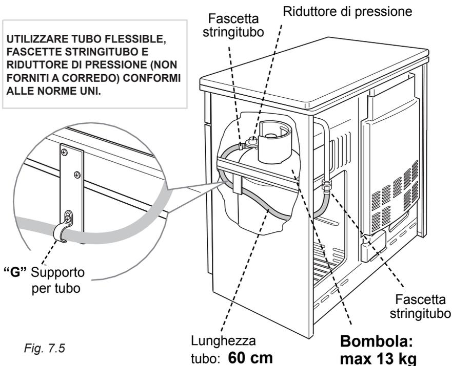
**IMPORTANTE:** Nel vano possono essere inserite soltanto bombole da max 13kg, e devono essere posizionate in modo da rendere facile la manovrabilità del rubinetto e del riduttore di pressione.
