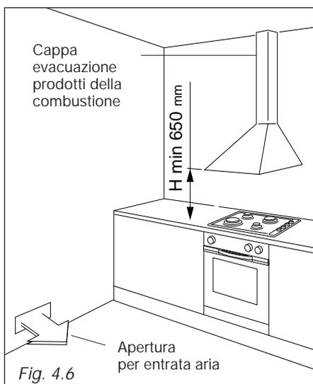
**Questo apparecchio non è raccordato ad un dispositivo di evacuazione dei prodotti della combustione. Esso deve essere installato e raccordato conformemente alle regole di installazione in vigore. Una particolare attenzione deve essere posta anche alla ventilazione del locale.**
