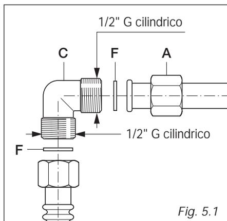
Il collegamento gas deve essere eseguito da un tecnico specializzato in conformità con le norme UNI-CIG 7129 e 7131.
