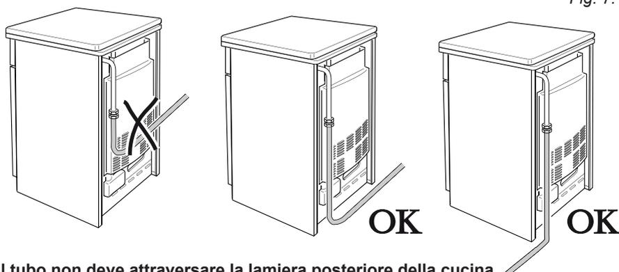
Il tubo non deve attraversare la lamiera posteriore della cucina. Eventualmente, se fosse necessario, far passare il tubo in vicinanza della parte inferiore dell'apparecchio.
