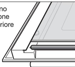
L'apertura tra la parte superiore del vetro e la guarnizione è appositamente prevista per permettere la circolazione dell'aria di raffreddamento.
