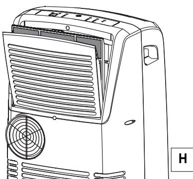
Odstranite prašinu koja se nakupila na filtru uz pomoć usisavača. Ako je filter prilično prljav upronite ga u mlaku vodu i isperite više puta. Temperatura vode treba biti niža od 40° C. Nakon što ste ga oprali, ostavite ga da se osuši.
