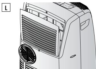
Odstranite prašinu koja se nakupila na filtru uz pomoć usisavača. Ako je filter prilično prljav uronite ga u mlaku vodu i isperite više puta. Temperatura vode treba biti niža od 40°C. Nakon što ste ga oprali, ostavite ga da se osuši. Postavite filter u njegovo prikladno sjedište.
