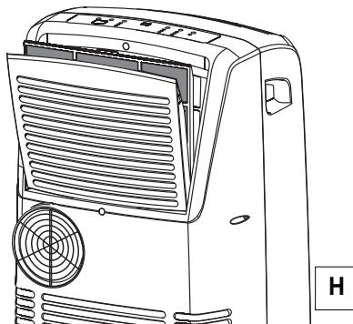
Odstranite prašinu koja se nakupila na filtru uz pomoć usisavača. Ako je filter prilično prljav uronite ga u mlaku vodu i isperite više puta. Temperatura vode treba biti niža od 40° C. Nakon što ste ga oprali, ostavite ga da se osuši.
