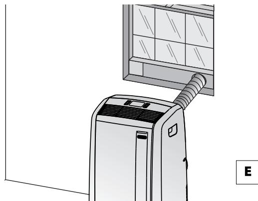
Svedite na minimum duljinu cijevi te zavoje istih (promjene smjera cijevi) na način da bi se onemogućila začepljenja.
