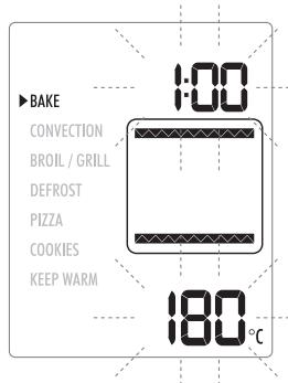
Promjenjive vrijednosti, vrijeme kuhanja i temperatura, trepere. Ako se ove vrijednosti ne postave, na zaslonu će se prikazati 1:00 h i 180 °C.
