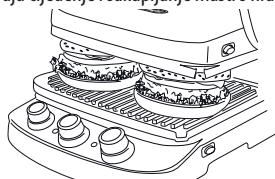
Kad se uređaj koristi u položaju "kontakt", preporučuje se uporaba rebrastih ploča. Položite poklopac jednolično na hrano dok ne dostigne željenu razinu pečenosti. Uređaj ima posebnu ručku i šarku koje omogućuju reguliranje poklopca ovisno o debljini namirnice.
