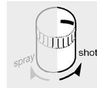
**Dampfstoß\* (kommt aus den Dampföffnungen der Bügelsohle):** Diese Funktion kann beim Bügeln im roten Bereich ① eingesetzt werden. Der
