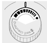
**Dampfmengen-Regler ④:** Stellen Sie die für jedes Wäschestück benötigte Dampfmenge mit dem Dampfmengen-Regler ④ ein (c). Durch Drehen des Dampfmengen-Reglers im Uhrzeigersinn bis zum
