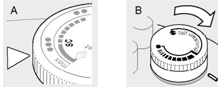
1. Drehen Sie den Dampfmenegler (4) auf Stellung «●» (= Dampf aus).
