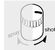
Die jeweils gewünschte Funktion kann durch Drehen des Knopfes ⑦ bis zum **Anschlag** gewählt werden. Die Markierung muß auf die entsprechende Funktion zeigen (blau = Wasser sprühen oder rot = Dampfstoß) (f). Von blau nach rot gegen den Uhrzeigersinn, von rot nach blau im Uhrzeigersinn drehen (f).
