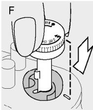
**ACHTUNG:** Das Bügeleisen darf nicht ohne Dampfmengen-Regler und ohne Anti-Kalk-Ventil benutzt werden.
