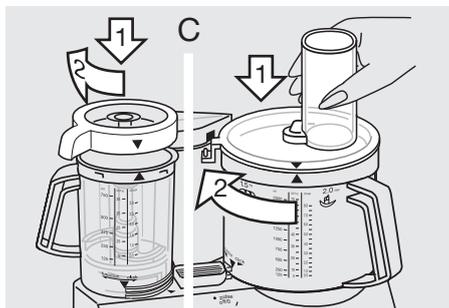
Em seguida, gire a tampa no sentido dos ponteiros do relógio levando o bico
