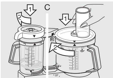
Luego gire la tapa en la dirección de las agujas del reloj guiando su punta hacia la apertura del cierre de seguridad en la base del motor ① hasta que de forma audible, encaje en su sitio.
