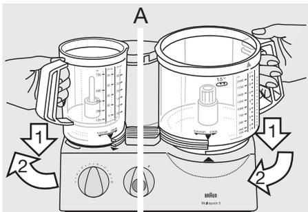
Luego gire el recipiente hacia la dirección «función» hasta que alcance el tope fijo más bajo. El recipiente sobre el otro conducto debe estar en posición vertical. Si es otro conducto está libre, cúbralo con la cubierta protectora ⑬.
