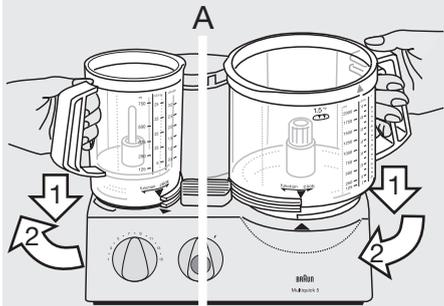
Dann drehen Sie den Arbeitsbehälter in Pfeilrichtung «function» bis zum Anschlag. Der Arbeitsbehälter bewegt sich dabei nach unten.
