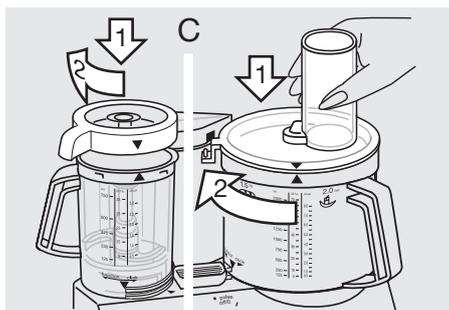
Drei så lokket i klokkeretningen slik at sporet på lokket føres inn i sikkerhetslås-åpningen på motordelen ① til du hører det klikker på plass.
