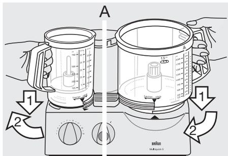
Puis tourner le bol dans la direction « fonction » jusqu'à ce qu'il atteigne le cran de blocage. Le bol de l'autre logement doit être placé en position haute. Si son logement est vide, poser le couvercle de protection ⑮.
