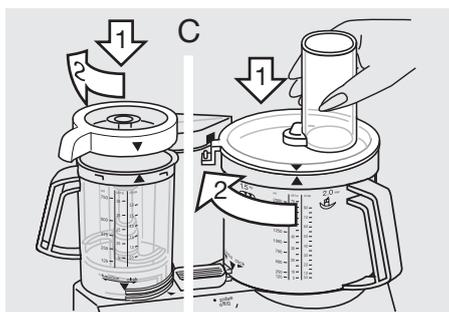
Tourner le couvercle dans le sens des aiguilles d'une montre jusqu'à ce que son bec verseur se place dans l'ouverture du blocage de sécurité du bloc-moteur ① en faisant entendre un click de blocage.
