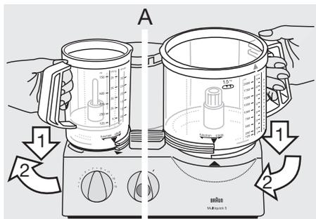
Herefter drejes skålen i «function» retningen, indtil den når den nedre position og går i hak. Skålen på den anden drivaksel skal være i løftet position. Hvis den anden drivaksel er ledig, bør beskyttelseshætten ③ sættes over.
