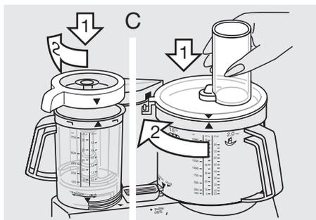
Następnie przekręcić pokrywkę w kierunku ruchu wskazówek zegara, aż nosek na pokrywce wsunie się do otworu zabezpieczającego bloku silnika ① i zatrzaśnie się.
