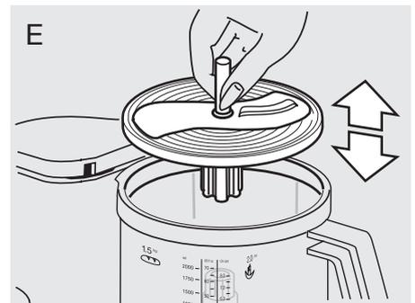
voedsel in de vulschacht van de deksel, terwijl de motor staat uitgeschakeld. Bijvullen altijd met uitgeschakelde motor.
