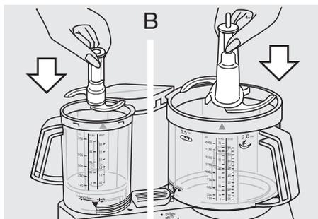
дого приспособления) на приводной вал емкости и нажмите на него вниз до тех пор, пока оно не достигнет крайнего нижнего положения (B). Когда Вы вставляете нож I в малую емкость ⑩, нажмите ее вниз таким образом, чтобы Вы услышали щелчок.
