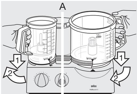
Μετά γυρίστε το μπολ προς της κατεύθυνση της λειτουργίας «function», μέχρι να σταθεροποιηθεί. Το μπολ στον άλλο οδηγό θα πρέπει να βρίσκεται σε ανασηκωμένη θέση (να μην είναι «κλειδωμένο» δηλαδή). Εάν ο άλλος οδηγός είναι ελεύθερος (δεν υπάρχει τοποθετημένο μπολ επάνω του), τοποθετήστε το προστατευτικό κάλυμμα ⑬.
