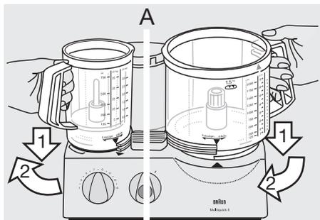
Draai de kom met de klok mee in de «function»-richting totdat deze vastklikt in de lagere positie. De kom op het andere aandrijfdeel dient in de hogere positie te staan. Als het andere aandrijfdeel vrij is, plaats hier dan de beschermkap ③ overheen.
