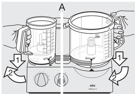
Następnie przekręcić pojemnik w kierunku strzałki «function» aż do oporu. Pojemnik roboczy opada przy tym na dół.
