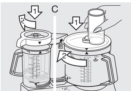
Drehen Sie den Deckel dann im Uhrzeigersinn, bis sich die Nase am Deckel in die Sicherheitsverschlussöffnung am Motorblock ① schiebt und hörbar einrastet.
