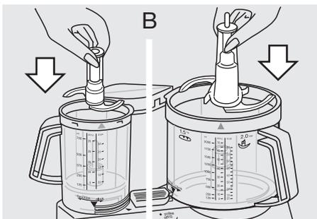
Cuando inserte la cuchilla ⑫ en el recipiente picador ⑩, empuje hacia abajo hasta que de forma audible encaje en su sitio.
