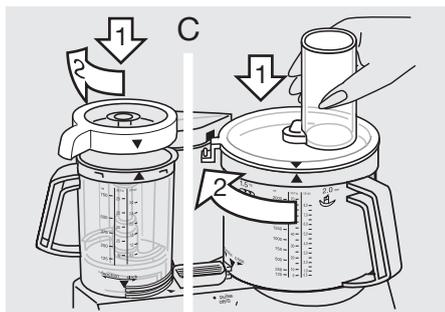
3. Накройте крышкой емкость ⑨ совместите стрелки, которые имеются на крышке и на емкости (C). Затем поверните крышку по часовой стрелке, направляя ее носик в отверстие запора безопасности моторного блока ① до тех пор, пока не будет слышен звук защелки.
