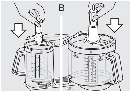
Beim Einsetzen des Messers ⑭ in den Zerkleinerertopf ⑩ ist darauf zu achten, dass das Messer hörbar einrastet.
