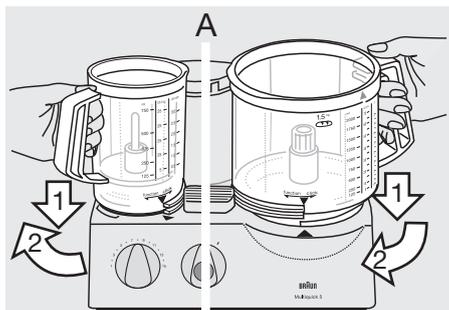
Затем следует повернуть емкость в направлении вращения до тех пор, пока будет достигнуто нижнее фиксированное положение. На другом приводном месте емкость должна находиться в поднятом положении. В том случае, когда другое приводное место свободно, следует установить на него защитный кожух ③.
