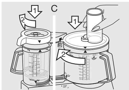
Drej låget med uret, således at tappen på låget passer i sikkerhedslåsen på motordelen ①, og indtil du kan høre, at det går i hak.
