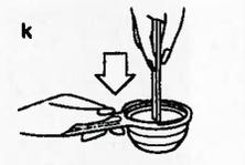
Si vous ne voulez préparer qu'une seule tasse d'expresso, remplissez complètement la cuillère de mouture à expresso. Posez le filtre rempli sur le porte-filtre puis le tout sur le support pivotant (l). Pour ouvrir le support pivotant, poussez le verrou en position «filter open» (ouverture du filtre).
