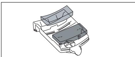
Στη συνέχεια τοποθετήστε το εξάρτημα φυσήματος μέχρι τέρμα και συνδέστε τον εύκαμπτο σωλήνα στο εξάρτημα.
