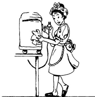
Στο τέλος της χρήσης της συσκευής μετά τον καθαρισμό με το σύστημα εξαγωγής ή και με το σύστημα αναρρόφησης υγρών συνιστάται, για μεγαλύτερη υγιεινή, η αναρρόφηση μερικών λίτρων καθαρού νερού από τη συσκευή για το ξέβγαλμα των εξαρτημάτων που χρησιμοποιήθηκαν. Με αυτό το τρόπο επιτυγχάνεται ο καθαρισμός των εξαρτημάτων και του εσωτερικού του εύκαμπτου σωλήνα.
