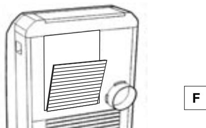
Για να αφαιρέσετε τη σκόνη που συσσωρεύτηκε στο φίλτρο, χρησιμοποιήστε ηλεκτρική σκούπα. Εάν είναι πολύ βρώμικο, βυθίστε το σε χλιαρό νερό και ξεπλύνετε το καλά.
