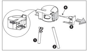
Rimontare quindi il cursore, il tubo di pescaggio e quello di erogazione latte dopo aver controllato che non siano otturati da residui di latte.
