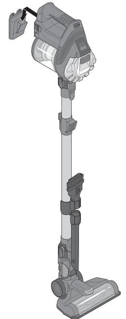
7. Accrochez le bloc-moteur au support monté sur le tube.
