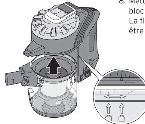
8. Mettez le bac à poussière en place sous le bloc moteur comme indiqué sur l'illustration. La flèche située au-dessus du symbole doit être en face du repère du bloc-moteur.
