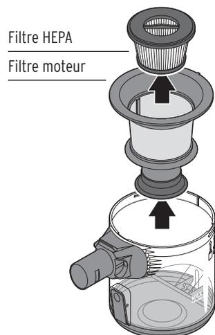
4. Sortez le filtre moteur et retirez le filtre HEPA du filtre moteur.
