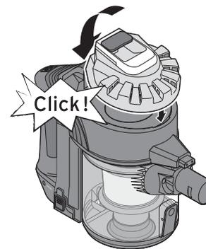
6. Mettez le couvercle en place d'abord par l'avant, puis enfoncez l'arrière au niveau du verrou. Vous devez l'entendre et le sentir s'enclencher.
