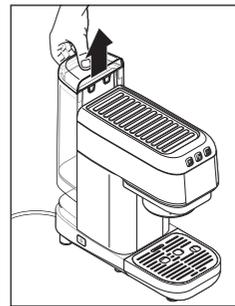
2. Sortez le réservoir d'eau de la machine en le tirant vers le haut.
