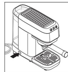
1. Pour allumer la machine, appuyez sur l'interrupteur marche/arrêt **⏻** sur le côté de la machine.
