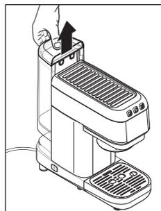
3. Avant de remplir le réservoir d'eau, sortez-le de la machine en le tirant vers le haut.
