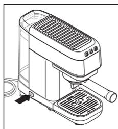
6. Allumez la machine avec l'interrupteur marche/arrêt
