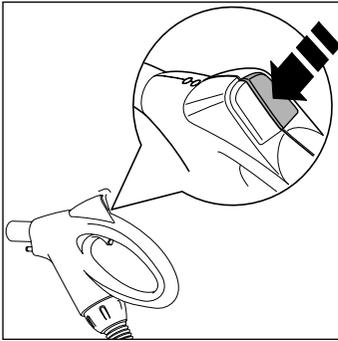
Pour activer la fonction aspiration, appuyez sur le bouton aspiration ON/OFF (21) situé sur la poignée du flexible : l'appareil atteindra la puissance maximale d'aspiration. Pour désactiver l'aspiration, appuyez une nouvelle fois sur le bouton aspiration ON/OFF (21).
