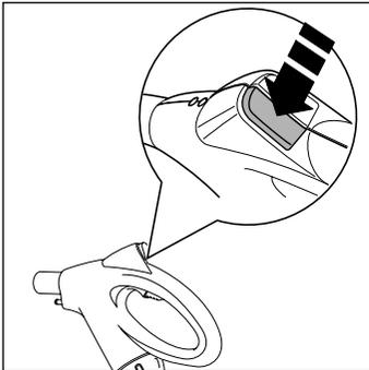
Pour diminuer ou augmenter la force d'aspiration du moteur, agissez sur le bouton (20) et maintenez la pression jusqu'à obtention de la puissance désirée.
