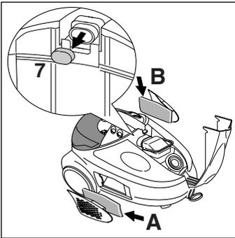
L'air usé passe dans **un filtre haute efficacité (A)** capable de retenir les particules de plus de 3 microns. Si ce filtre est sale, il faut le remplacer.
