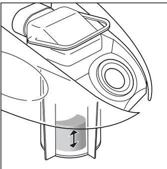
Contrôlez périodiquement si le flotteur dans le panier bouge librement et si le filtre en polyuréthane (4) et le filtre à air (7) sont présents et bien positionnés.
