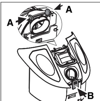
Retirez le couvercle du bidon avec système flotteur
