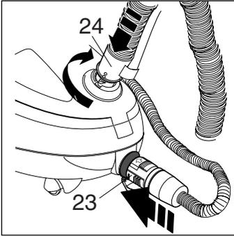
Montez le flexible (25). Introduisez la fixation à baïonnette (24) dans le trou prévu sur le couvercle de fermeture (1) et appuyez à fond en vissant jusqu'au bout.
