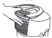
Contrôlez périodiquement si le flotteur dans le panier protection moteur bouge librement dans son logement : soulevez et secouez l'unité moteur.
