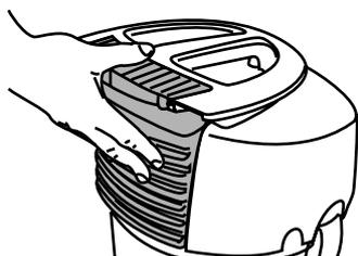
Contrôlez périodiquement si le flotteur dans le panier protection moteur bouge librement dans son logement (fig. 11) : soulevez et secouez l'unité moteur.
