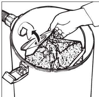
Le sac de récupération en papier doit être monté à l'intérieur du bidon, en enfilant le collier en carton autour de la partie intérieure de la bouche d'aspiration, en poussant bien à fond.
