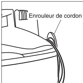
Pour ranger l'appareil mettre les accessoires sur le porte-accessoires et enrouler le cordon autour de l'enrouleur de cordon.
