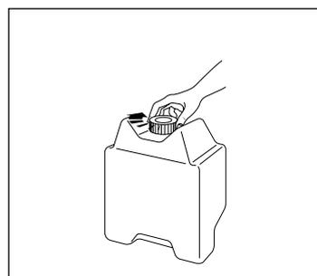
C) Une fois le remplissage terminé, remettez en place le tuyau extensible, serrez bien à fond le bouchon et placez le réservoir dans son logement avec l'inscription FRONT en vue.
