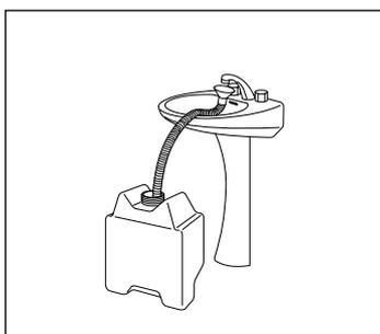
B) Enlevez le bouchon, retirez le tuyau extensible et remplissez le réservoir en le laissant posé sur le sol.
