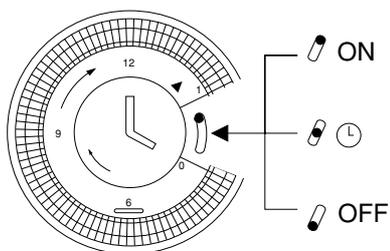
Quand l'interrupteur du programmeur/timer se trouve sur la position OFF, l'appareil ne fonctionne pas.
