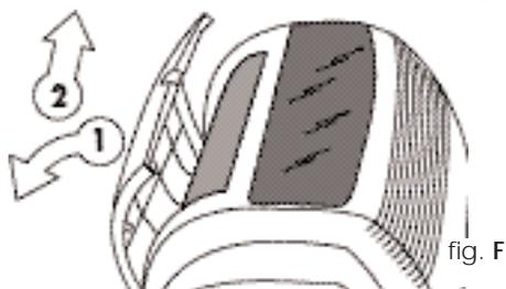
Pour éliminer la poussière qui s'est déposée sur le filtre, utilisez un aspirateur. Si le filtre est très sale, plongez-le dans de l'eau tiède et rincez-le ensuite plusieurs fois. La température de l'eau doit être inférieure à 40°C.
