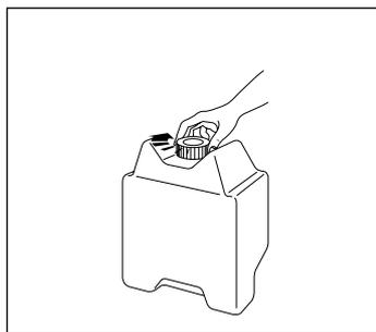
C) Une fois le remplissage terminé, remettez en place le tuyau extensible, serrez bien à fond le bouchon et placez le réservoir dans son logement avec l'inscription FRONT en vue.
