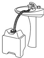
Retirer le bouchon, extraire le tube extensible et procéder au remplissage en laissant le bidon posé à terre.
