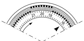
**N.B:** ne jamais faire tourner le quadrant en sens inverse: Le timer est une horloge électrique et fonctionne uniquement lorsque la fiche est connectée au réseau. Chaque fois que la fiche est désinsérée ou que le courant manque, le programmeur s'arrête (l'horloge reste "en arrière"), ce qui rend nécessaire un nouveau réglage de l'horloge.
