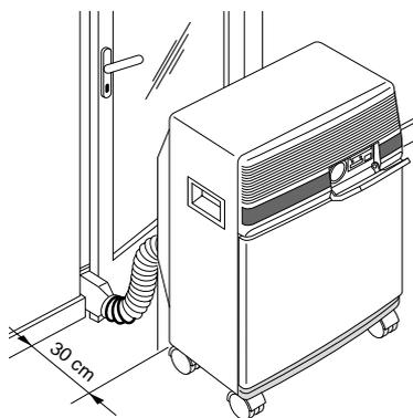
soit installé sur un sol "plat". Insérer éventuellement les deux dispositifs de blocage des roues.
