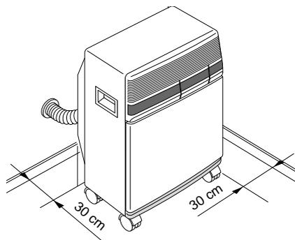
L'espace entre le climatiseur et le mur doit être d'au moins 30 cm.
