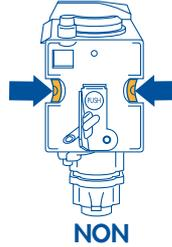
**NOTA 1:** : Si l'infuseur n'est pas inséré correctement jusqu'au dé clic de blocage et si les touches rouges ne sont pas ressorties correctement, le volet ne se fermera pas et vous ne pourrez pas faire marcher la machine (si vous la mettez en marche, le voyant
