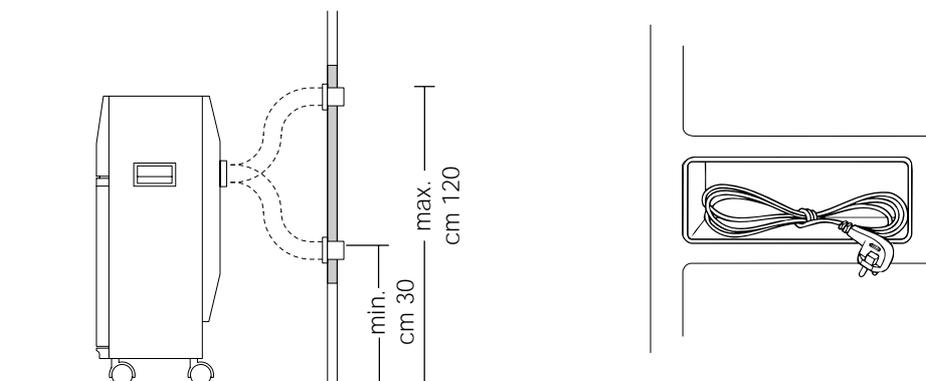
Lorsque l'installation d'évacuation est réalisée avant mise en place de l'appareil nous conseillons de boucher l'orifice avec le bouchon en dotation.
